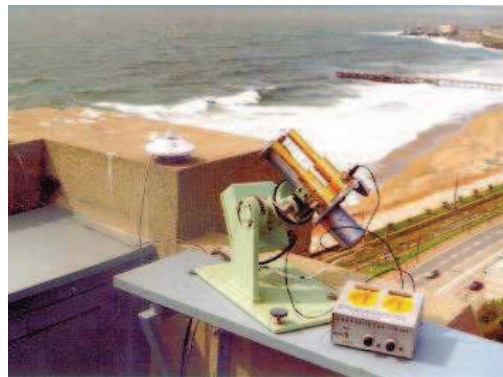
Estación de monitoreo de radiación UV.
